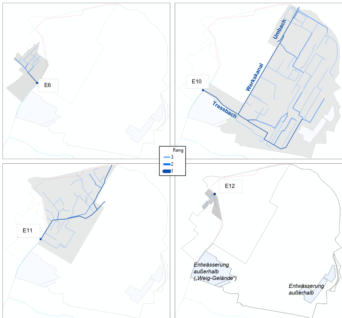
Abbildung 3-4: Ab- und Einleitung des Regenwassers auf dem Zanders-Areal im Bestand, Kartengrundlagen [Projektgruppe Zanders-Areal (2022)] und [Hydrotec (2021)]
