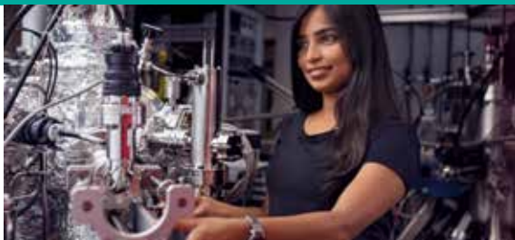
Molekularstrahlepitaxie zur Herstellung von Quantenmaterialien
